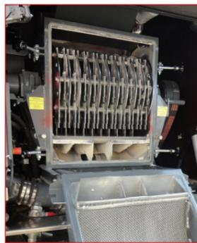
Le broyeur est standardisé avec l'équipement de 160 marteaux. Broyage amélioré grâce à une augmentation de la surface de tamisage de 30% (1,1 m<sup>2</sup>). Le changement du tamis est très simple. Répartition équilibrée du matériau et montage variable des marteaux pour une performance de broyage jusque 35 t/h.
